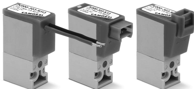
Электропневматические распределители прямого действия Серии К могут работать на воздухе как с распыленным маслом, так и без масла. Они поставляются 3/2 лин./поз. нормально закрытые или нормально открытые. Монтажные плиты могут быть как одноместными, так и многоместными. На эти плиты можно монтировать и Н.З. и Н.О. клапаны (но для последних нужен специальный переходник).
