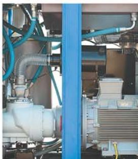
**Двухступенчатая система маслоотделения** обеспечивает остаточное содержание масла в сжатом воздухе не более 3 мг/м<sup>3</sup>.
